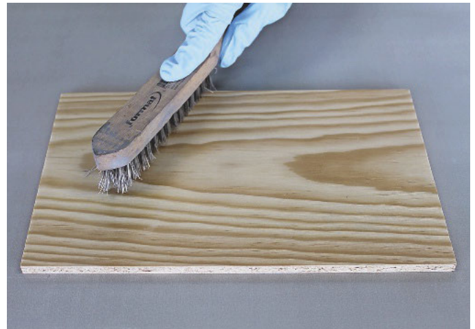
2. Strukturieren. Der gewünschte Effekt bestimmt das Werkzeug: eine Stahl- oder Nickelhandbürste oder eine rotierende Litzendraht- oder Anderlonbürste
