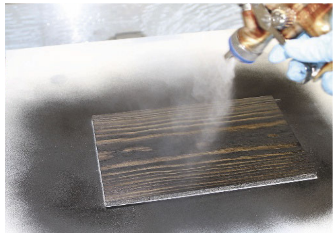
4. Auftrag der Grundierung mit einer Becherpistole, PUR-Schichtlack 120 g/m 2 . Die Trocknung dauert acht Stunden bei Raumtemperatur
