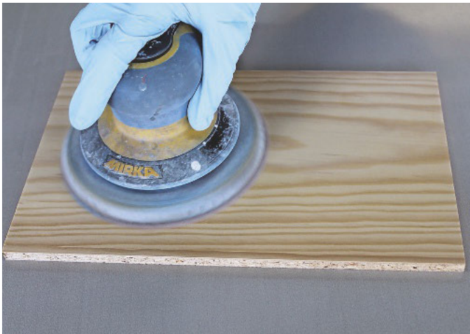
1. Vorbereiten der Fläche: Schliff des rohen Holzes mit Korn 120 bis 150. Dies kann maschinell, mit dem Exzentrerschleifer oder manuell erfolgen
