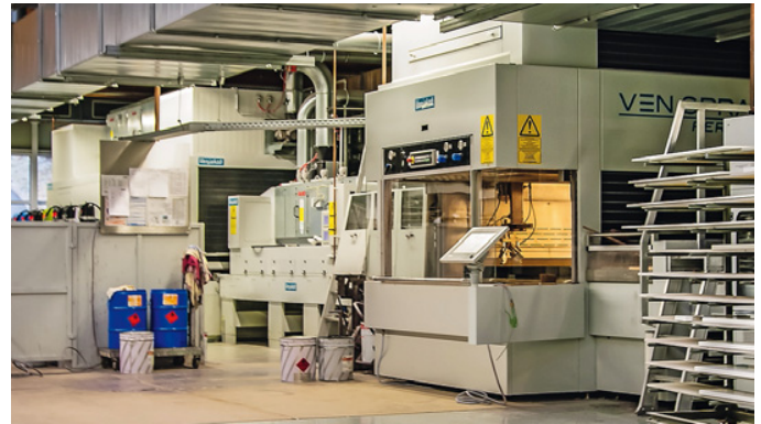
Der Flächenspritzautomat lackiert auch alle vier Schmalflächen. Den Lack auf dem Transportband gewinnt die Anlage zurück
