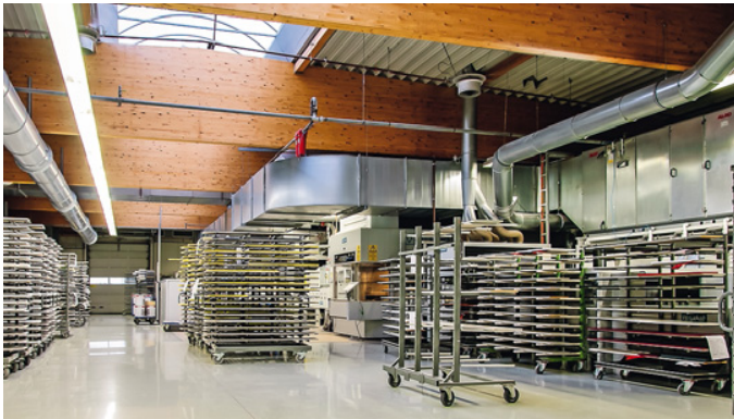
Die Lackierstraße mit Flächenspritzautomat und Turmtrockner bei Burgbad in Bad Fredeburg
