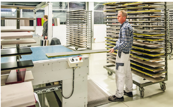
Der Maschinenführer legt die geschliffenen und im Kantenbereich vorbehandelten Fronten aufs Band
