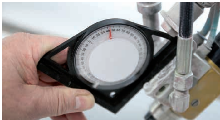
Pistoolhoek vlakke delen ca. 45°, geprofileerde delen 50 - 60°
