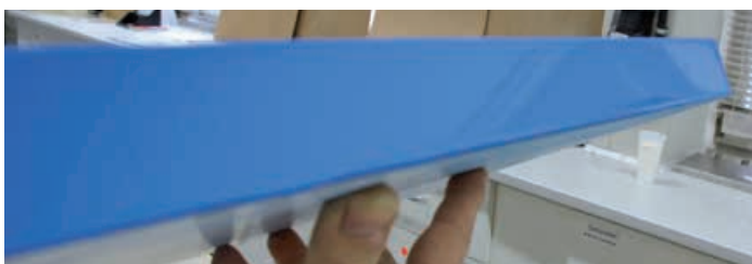
Lopers aan de randen = overspuitwaarde verminderen
