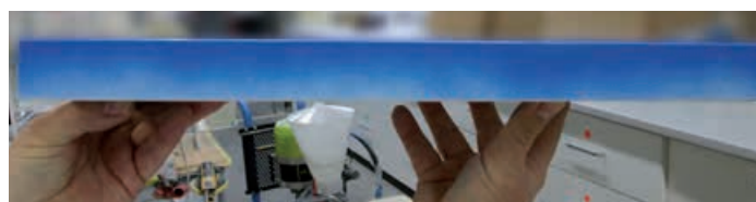
Geen benetting aan de randen = overspuitwaarde verhogen
