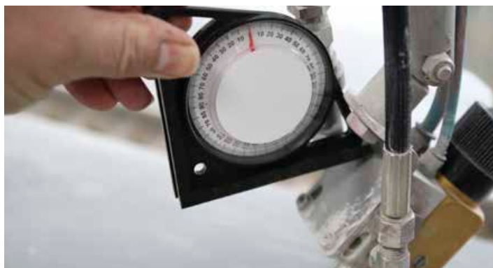
Standaardwaarde pistoolhoogte 8 - 10 cm boven het werkstuk
