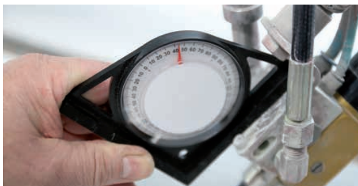
Nachylenie pistoletu: płaskie elementy ok. 45°, profilowane elementy 50–60°
